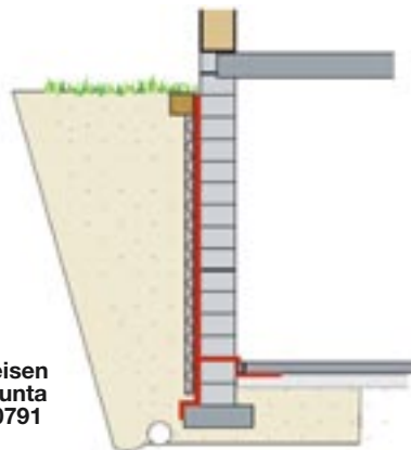
Kuva 3: Perusmuurin ja maanvaraisen laatan liitoksen tiivistäminen RT-ohjekortin RT 81-10791 mukaisesti.
